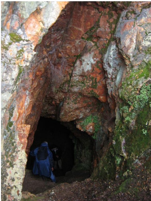
Una de las abundantes galerías practicadas en la dura roca cuarcítica. En todos los casos, se seguía la dirección de los diques de cuarzo potencialmente aurífero.
