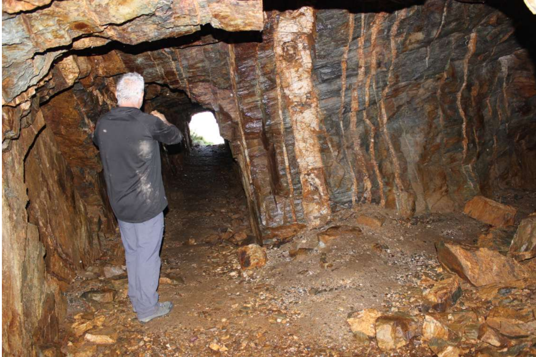
Vista desde una de las galerías principales de la planta cero. Se observan las capas de esquisto atravesadas, perpendicularmente, por los diques de cuarzo donde se encuentra alojada la wolframita.
