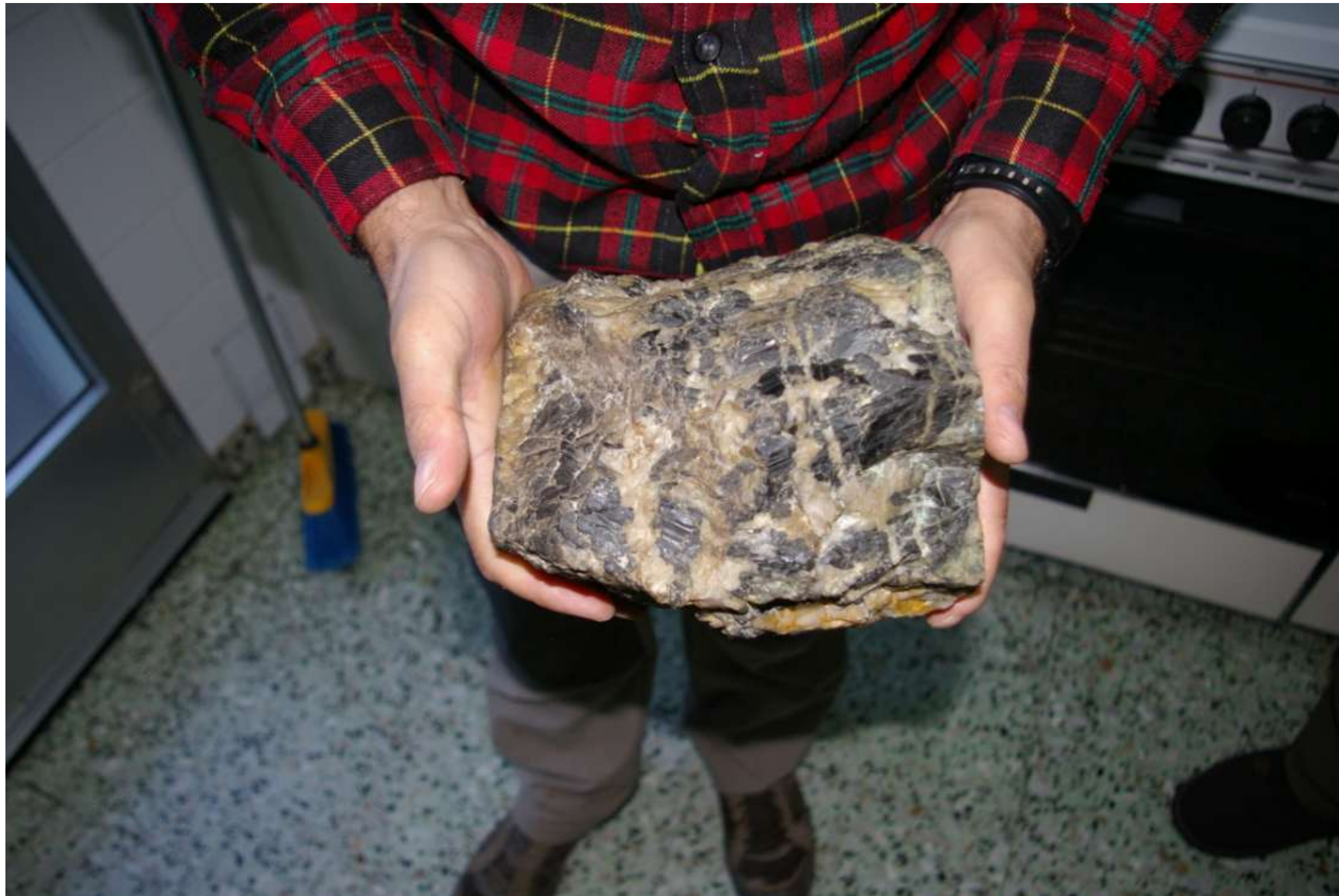
Aspecto del ancho de un filón de cuarzo relleno del mineral del wolframio, la wolframita, con su característico color negro antracitoso.
