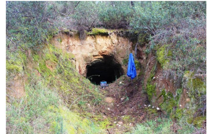
Aunque lo habitual es ver trincheras mineras, practicadas para la localización de los minerales del wolframio, y que siguen el cortejo filoniano en dirección NO-SE, en ocasiones se pueden ver galerías mineras como la de la foto, de 56,5 metros de longitud, que resultó estéril en los minerales buscados.
